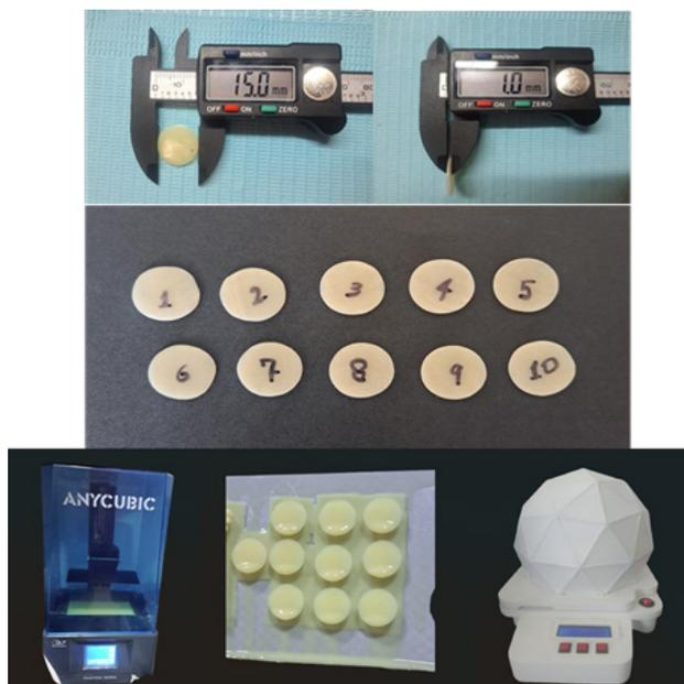
**Figura 3.** Calibración de las muestras (arriba). Muestras de PMMA etiquetadas (medio). A: Impresora “ANYCUBIC” B: Muestras impresas C: Cámara de postpolimerización (abajo).
