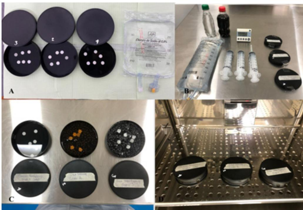
**Figura 1.** Proceso experimental. 1A. Discos de resina asignados a cada grupo. 1B. Materiales y sustancias para sumergir cada grupo de discos según su asignación. 1C. Discos de resina sumergidos en la sustancia correspondiente según su asignación. 1D. Discos de resina almacenados en la incubadora.
